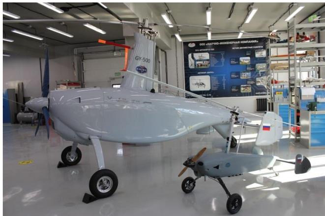
Летающий опытный образец Автожир УБТК «GY-500» и «GY-30» – уникальный беспилотный летательный аппарат для обширного спектра использования
